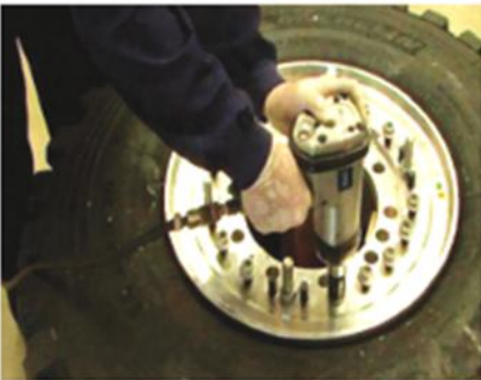
40. ナットを取り付け、24mm ソケットで、4個のナットを締める。
