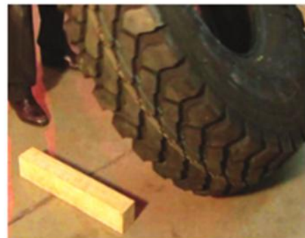
23. フォークリフトの爪を下に入れるために。止め木をおき、その上にタイヤを寝かせる。
