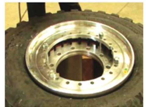
36. クランプボルトを手で止めた状態。
