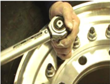
43. 22個のナットを217Nmで締める。
