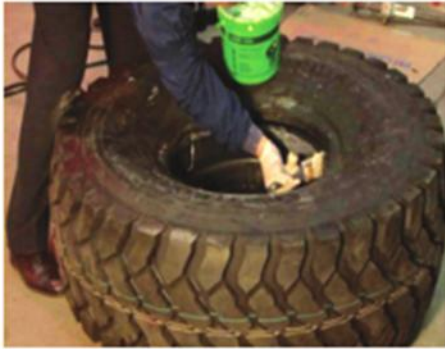
25. ランフラットの内側に潤滑油を十分に塗る。
