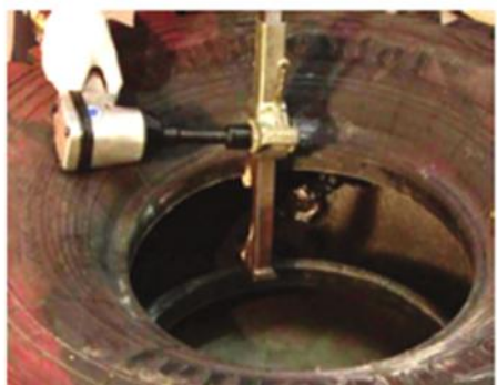
4. 必要に応じて、作業をしやすくするために道具でビードを広げる。ボトルジャッキを使用することも可能。
