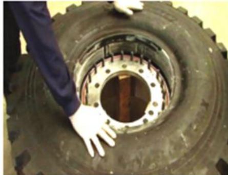
29. 体重を掛けてホイールにタイヤとランフラット押し込む。
