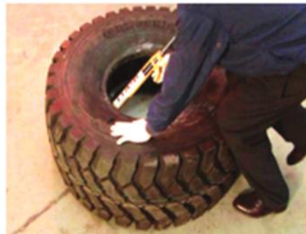
3. タイヤの内面に潤滑油を均等に塗布する。
