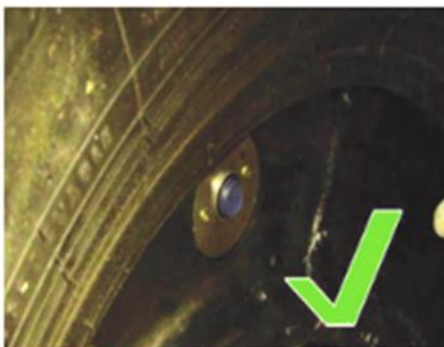
19. ボルトがロックリングに入っていることを確認する。締め過ぎには注意すること。
