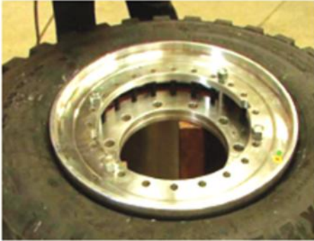
37. クランプボルトを手で止めた状態。
