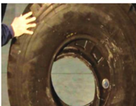
22. タイヤを回転させて、3 箇所の接続部を締める
