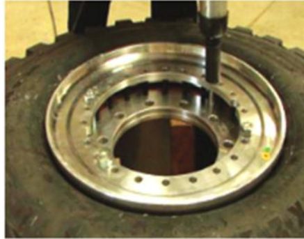
38. 1本締めた後、その反対側のクランプボルトを締める。それを繰り返すことでフランジが均一に固定される。
