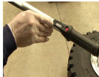
20. Torque to 55Nm.
