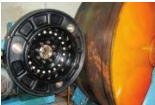
ローラー式模擬道路に Tyron ATR を設置し、試験を実施
