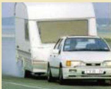
113mph (181km/時) でパンクさせ、106mph (170km/時) で緊急停止させる試験を行ったが、車両は停止し、問題はなかった。トレーラーを付けずに前輪がパンクした状態にしても、130mph (208km/時) で 4km を走行した。ハンドル操作に問題はなく、タイヤとホイールは傷つかなかった。
