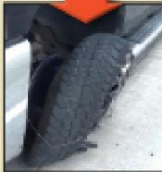
タイヤの空気が抜けるにつれて、ホイールが道路に接触するようになり、ハンドル操作が制御できなくなります。
